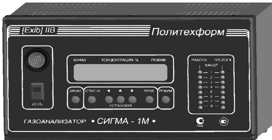
Рис. 1. Общий вид информационного пульта газоанализатора "СИГМА-1М"
