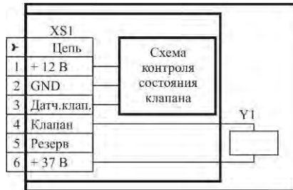
Обозначения: XS1 – разъем РГ1Н-1-3; Y1 – электромагнит.
