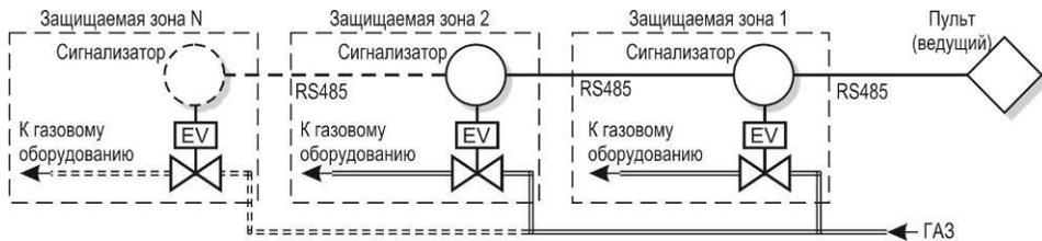
Рисунок 10 – Система с индивидуальной защитой и связью по RS485.
