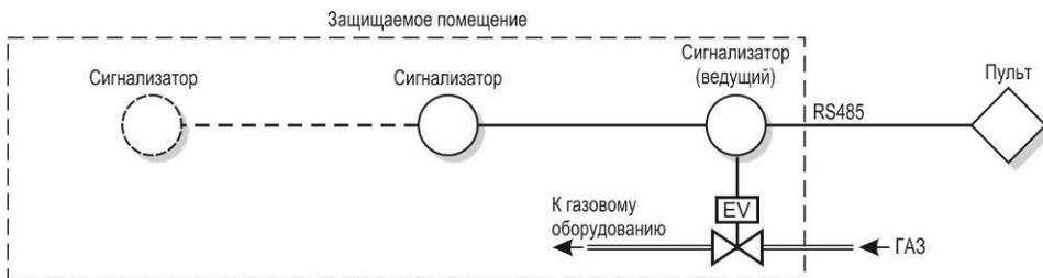
Рисунок 12 – Система с групповой защитой и связью по RS485
