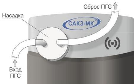
Рисунок Д.2 – Установка насадки для подачи ПГС
