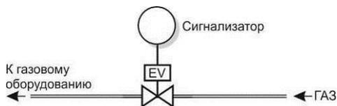
Рисунок 8 – Система с одним сигнализатором без пульта
