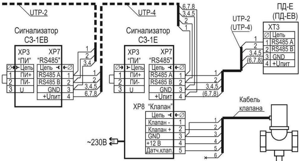
Для сигнализаторов и пульта исполнения «ЕВ» используется кабель типа UTP-4, для исполнения «Е» – типа UTP-2.
