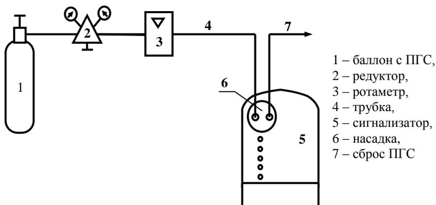
Рисунок Д.1 – Схема для настройки и поверки сигнализаторов СЗ-1Е с применением ПГС
