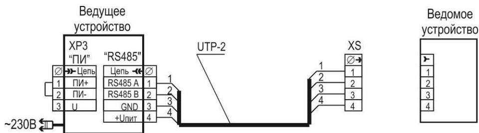
Рисунок 7 – Схема для программирования адресов
