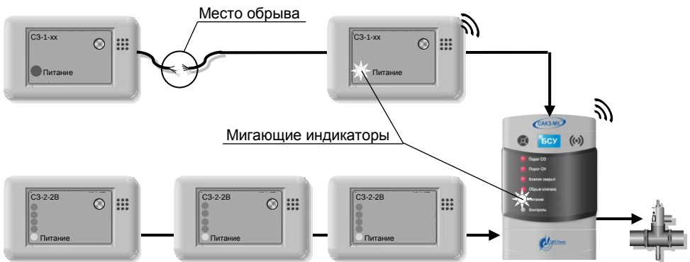
Рисунок 3 – Реакция системы на обрыв кабеля
