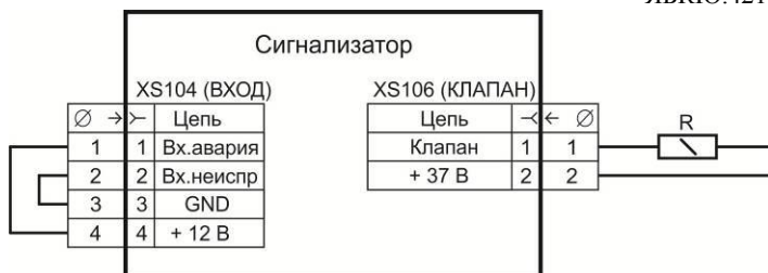
Рисунок Г.1 – Установка перемычек и имитатора клапана
