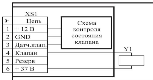
Рисунок 8 – Клапан КЗГЭМ-У. Схема электрическая принципиальная
