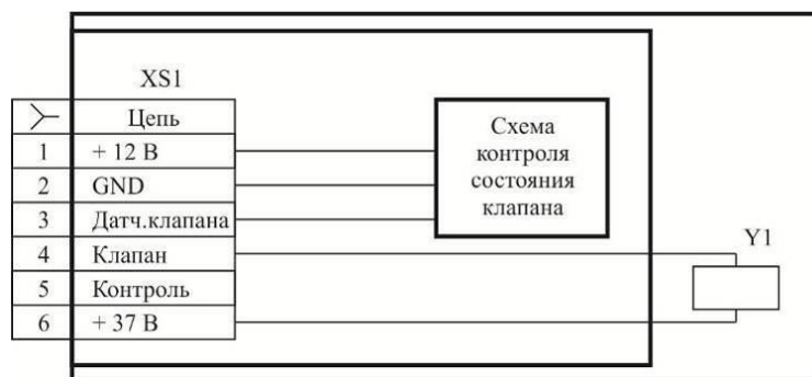
Рисунок 8 – Клапан КЗГЭМ-У. Схема электрическая принципиальная.
