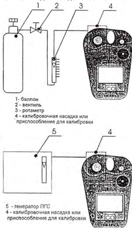
Рис. 1. Схема соединения газоанализатора с источником ПГС
