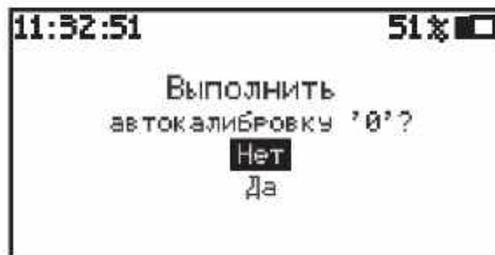
После чего начнется 45-секундный цикл прогрева сенсоров и продувки газовой камеры, на индикаторе отображается обратный отсчет времени до его завершения. После цикла прогрева и автокалибровки газоанализатор переходит в рабочий режим (режим измерений).
