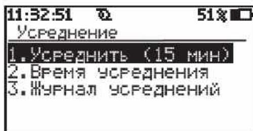
При запуске усредненных измерений автоматически включается насос и прибор переходит в режим измерений. В служебной строке вместо текущего времени отображается обратный отсчет заданного времени усреднения. Процесс усредненных измерений можно прервать, нажав кнопку
