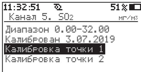
В открывшемся окне будет отображаться измеряемая концентрация, соответствующий ей первичный сигнал (АЦП), а также сохраненные калибровочные параметры (концентрация С1 (или С2) и соответствующий ей первичный сигнал V1 (или V2)). Отметим, что для оптических и сенсоров и отображается только измеряемая концентрация и значения ПГС предыдущей калибровки. Для полупроводниковых сенсоров первичный сигнал АЦП не отображается.
