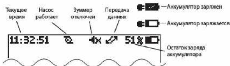
Если выбраны постоянные измерения, концентрация отображается постоянно, если измерения управляемые – только при включенном встроенном насосе. Если насос выключен, вместо измеренных значений отображаются прочерки.
