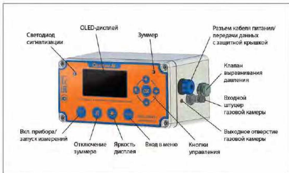
Рис.2. Газоанализатор "Сенсон-М". Органы управления
