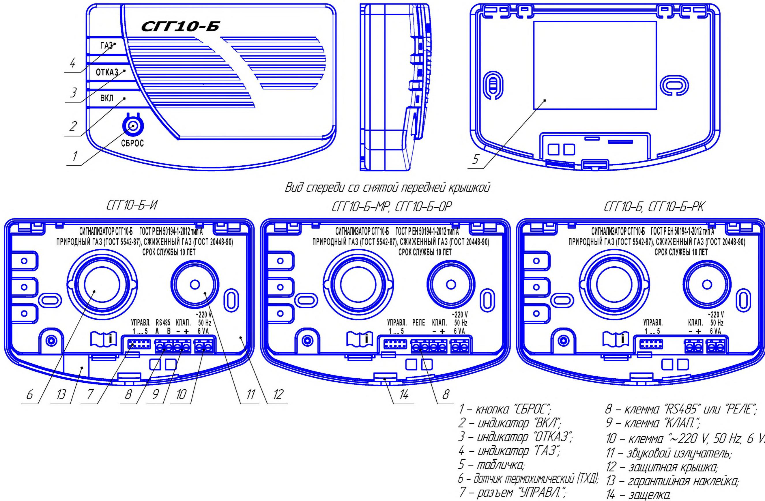
Рисунок 11 (а) – Сигнализаторы горючих газов СГГ10-Б. Внешний вид.
