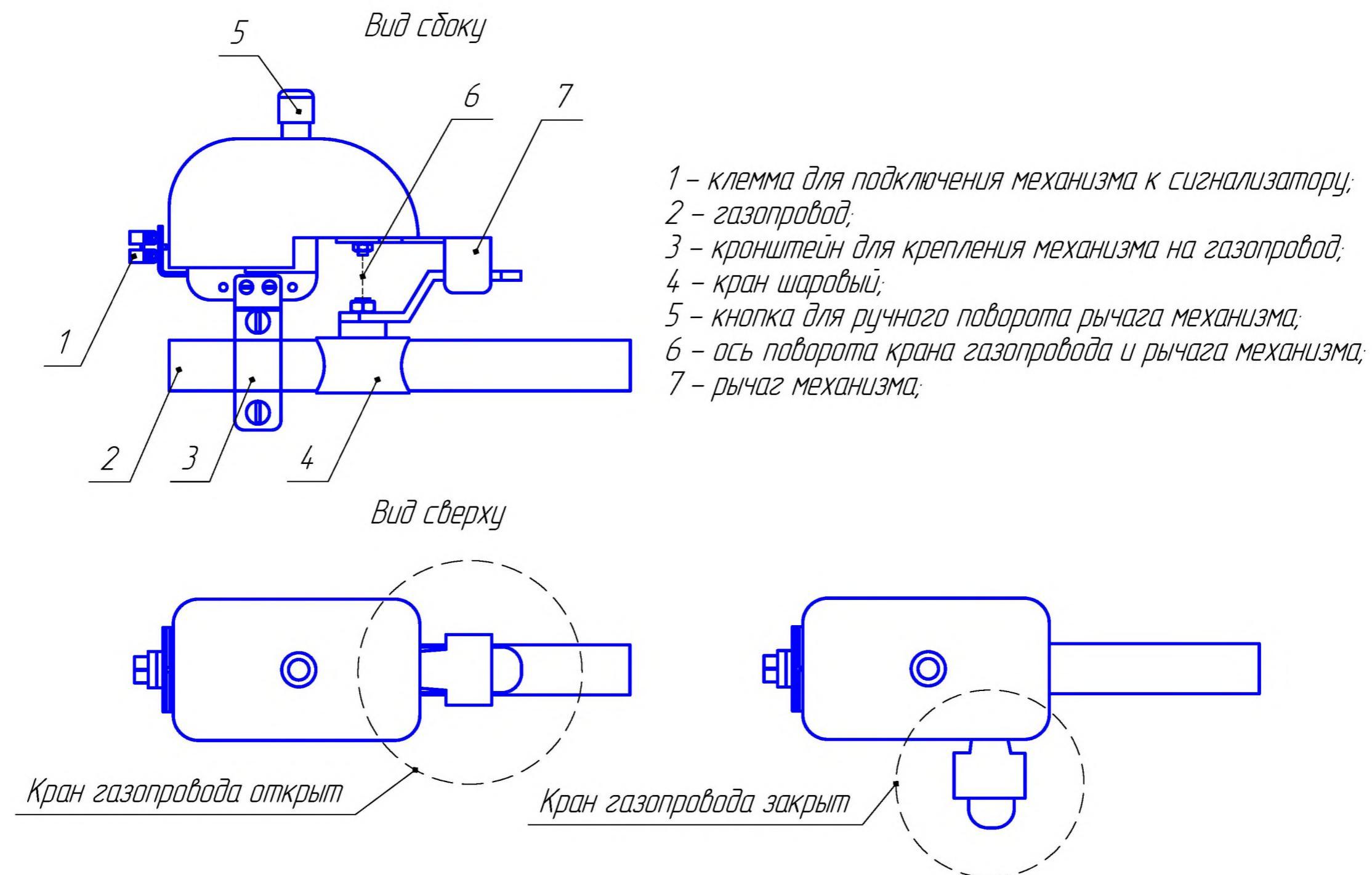
Рисунок 2.1 – Механизм отключения подачи газа. Внешний вид.
