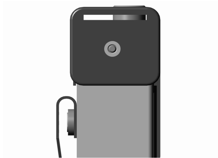
Рис.4. Расположение гайки, закрывающей доступ к регулировочным потенциометрам
