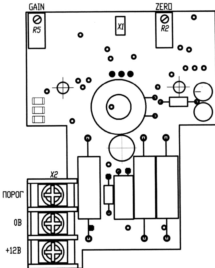
**ПРИЛОЖЕНИЕ 3****Клеммник и таблица соединений блока сигнализации с датчиками**
