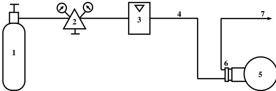
1 – баллон с ПГС; 2 – редуктор; 3 – ротаметр; 4 – трубка; 5 – сигнализатор;
