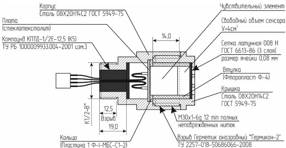
1 Взрывонепроницаемость сенсора обеспечивается заключением чувствительного элемента во взрывонепроницаемую оболочку, состоящую из корпуса и крышки, образующих взрывонепроницаемое соединение.
