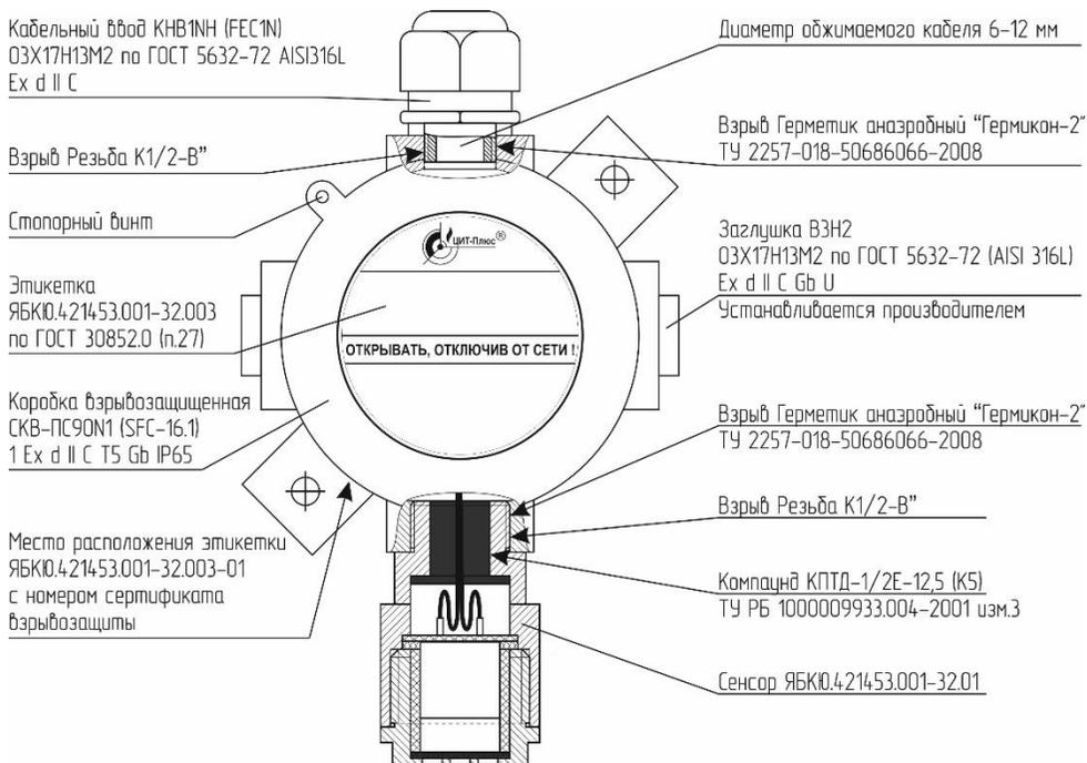
1 Для подведения питания применен кабельный ввод КНВ1НН (FEC1N) ExdIIС. Для герметизации ввода применены втулки из эластичного материала из комплекта кабельного ввода.
