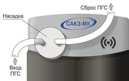
Рисунок Д.2 – Установка насадки для подачи ПГС
