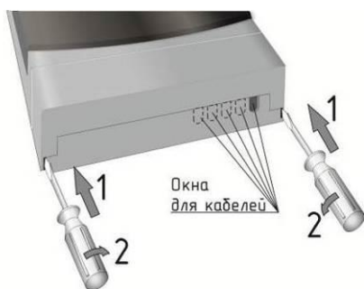
Рисунок 2 – Снятие крышки клеммного отсека
