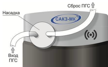
Рисунок Е.1 – Установка насадки для подачи ПГС
