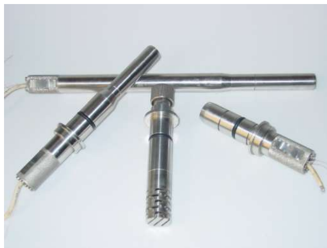
Рис. 3.6. Внешний вид стерилизуемых амперометрических сенсоров ACSrO 2 -06.
