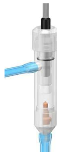
Рис.3.2. Внешний вид сенсора в измерительной камере.
