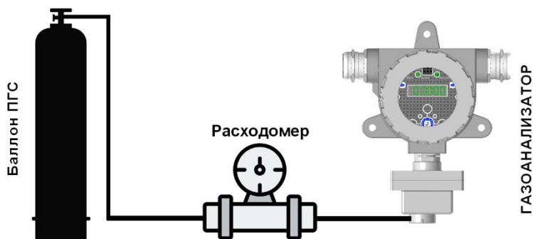
Рисунок 18 - Схема оборудования для установки нуля датчика контролирующего CO 2
