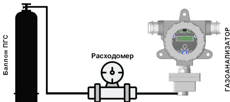
Рисунок 19 - Схема оборудования для корректировки чувствительности
