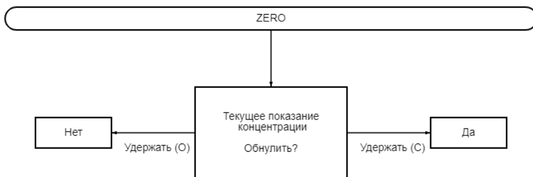
Рисунок К.2.6 – Алгоритм градуировки нуля
