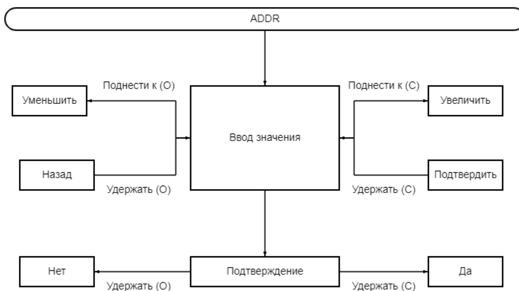
Рисунок К.2.9 – Алгоритм изменения адреса MODBUS
