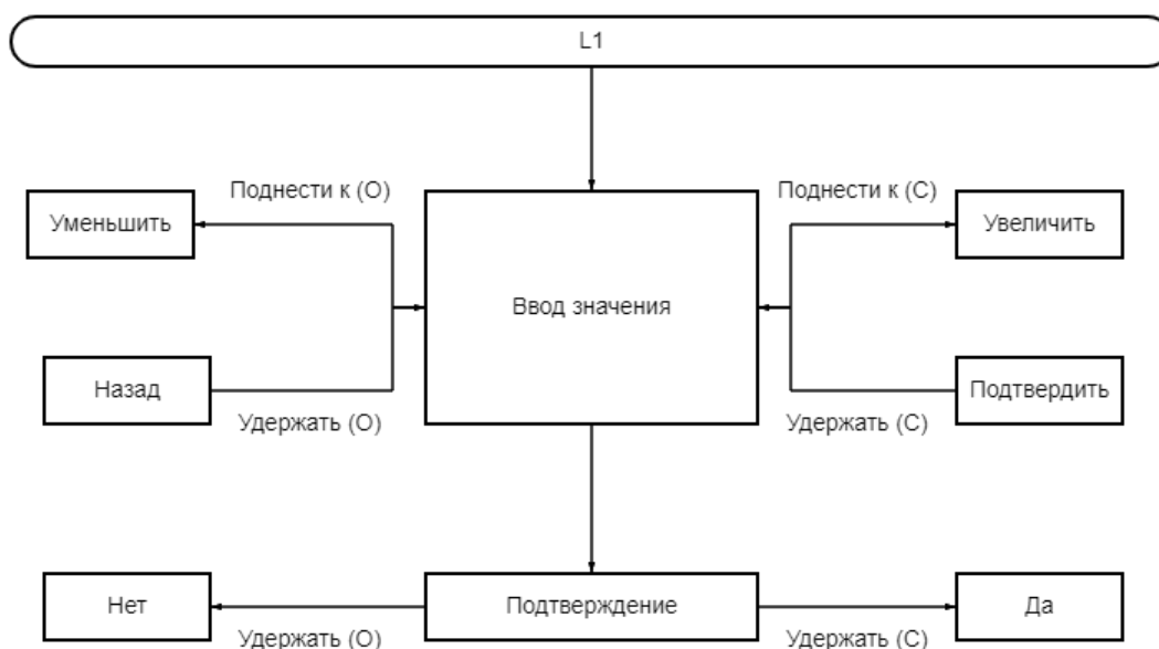
Рисунок К.2.16 – Алгоритм настройки Порога 1
