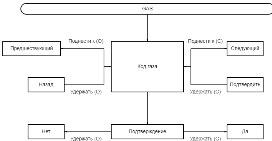
Рисунок К.2.8 – Алгоритм переключения газа
