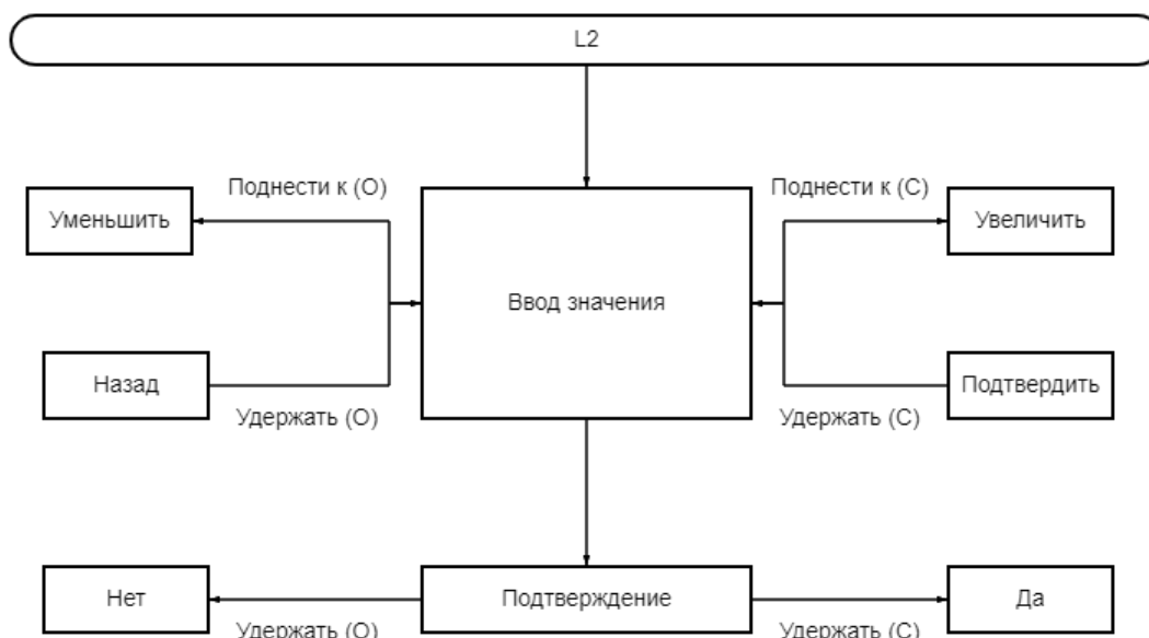
Рисунок К.2.4 – Алгоритм настройки Порога 2
