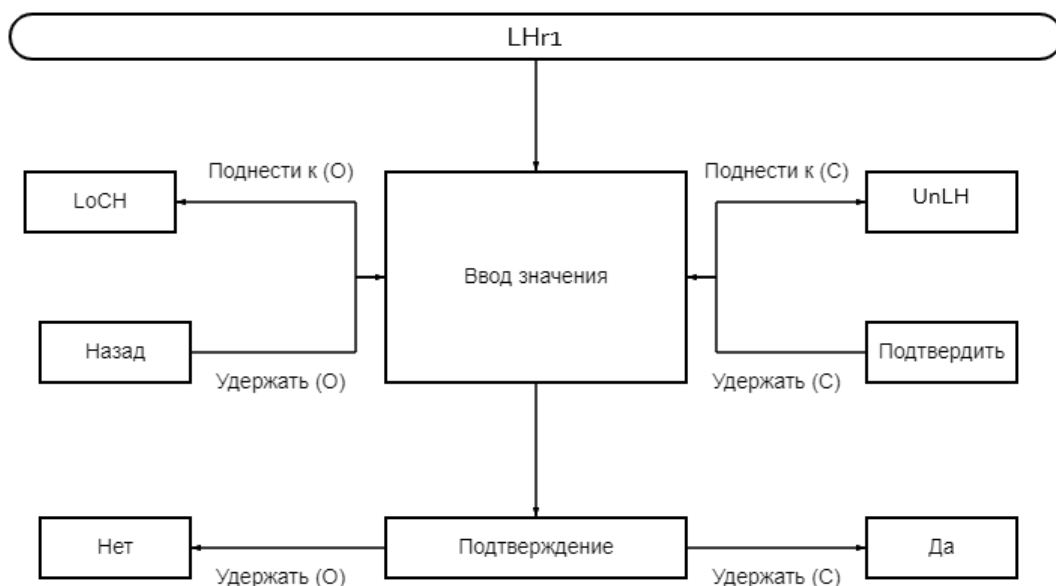
Рисунок К.2.11 – Алгоритм включения/отключения блокировки реле 1 при превышении порога 1
