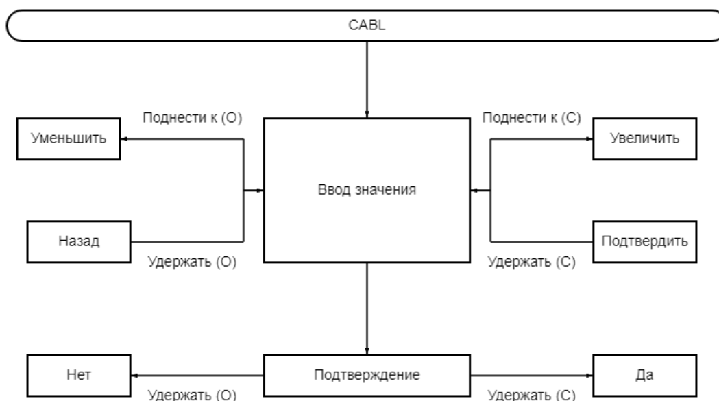
Рисунок К.2.5 – Алгоритм градуировки концентрации
