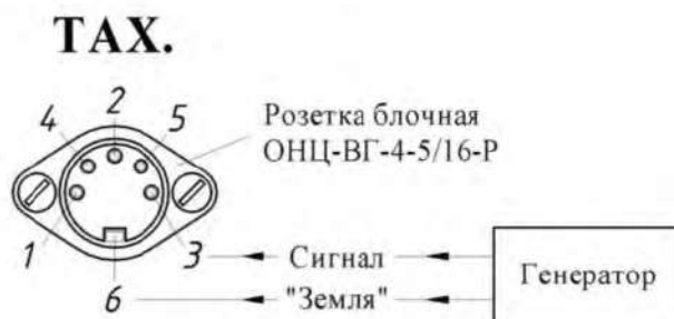
Рис 10 Схема подключения дымомера к генератору сигналов
