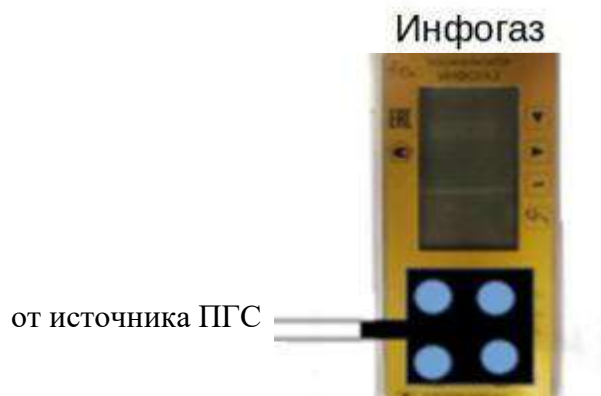
Рис. 3.1. Подача ПГС в адаптер при проверках
