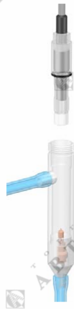
Рис. 3.9. Установка АСрО 2 в измерительную камеру.
