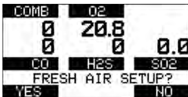
Рис. 7 Настройка по чистому воздуху
