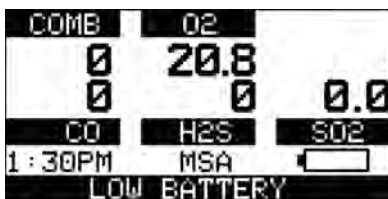
Рис. 4 Сигнализация разряда батареи
